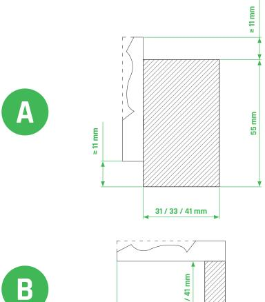
IMPORTANT For stud 70 = 31 mm For stud 75 = 33 mm For stud 90 = 41 mm
